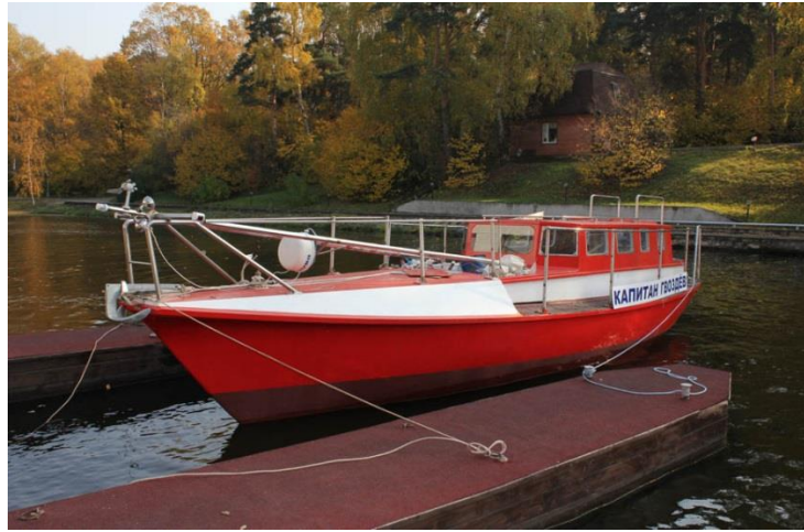
Рис 12. Яхта с корпусом из наноцемента (толщина стенки бортов 12 мм) на Клязьминском водохранилище Московской области, 2009 г.
